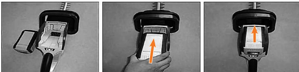
2. Снятие аккумуляторной батареи. Нажмите и удерживайте кнопку фиксатора аккумулятора в нижней части батарейного блока. Извлеките аккумулятор из устройства.
