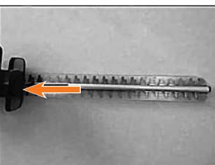
4. Соберите режущий механизм. Для обеспечения безопасности и хранения, пожалуйста, надевайте защитный кожух после каждой операции.
